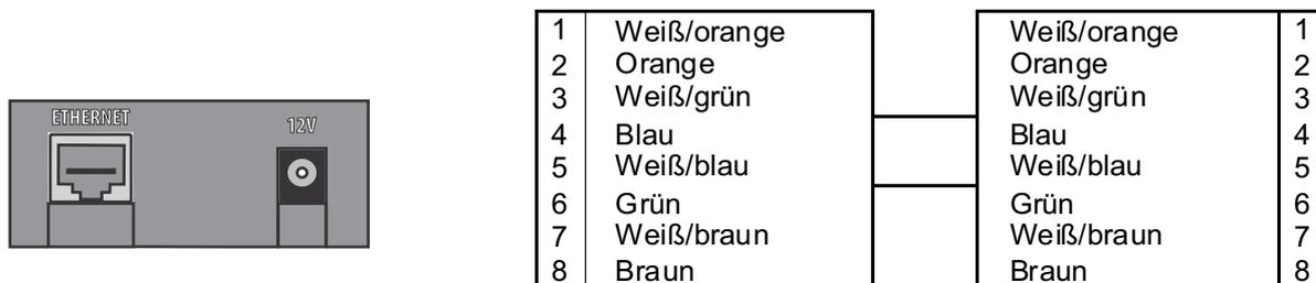
**ETHERNET** RJ45-Steckverbindung zum Anschluss an LAN-Netzwerke. Benötigt ein standardmäßiges, gerades Ethernet-Patchkabel.
