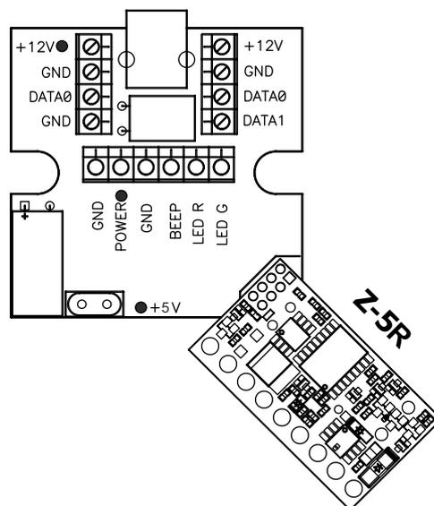
**7.2. Conexión de un Matrix II K**
