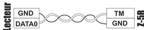
**Figure 3.** Raccordement du lecteur par câble UTP CAT5e.
