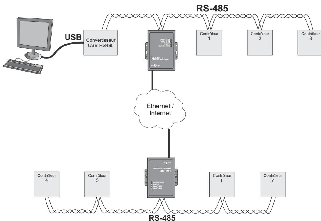
Exemple de configuration en mode pont Ethernet.
