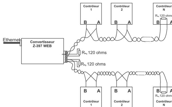
Exemple de raccordement pour un convertisseur branché en milieu de chaîne RS-485.
