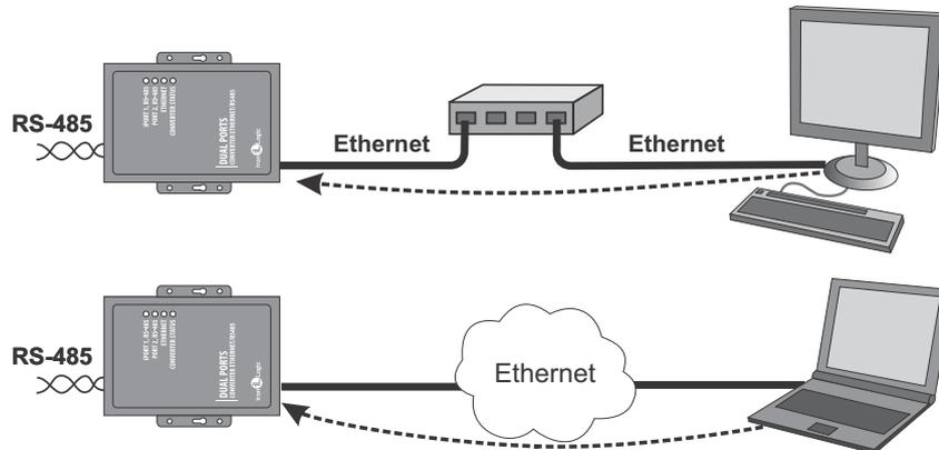
Ce mode est pratique lorsque l'adresse IP du convertisseur est connue ou lorsque les paramètres et la structure du réseau permettent au logiciel de la détecter.
